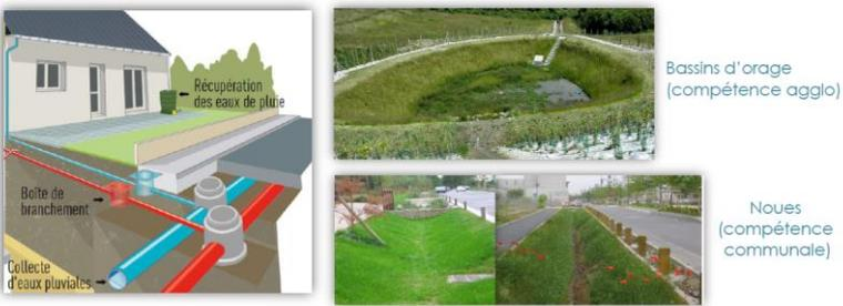
Le diagramme à gauche illustre la récupération des eaux de pluie d'un toit vers une citerne souterraine, avec des étiquettes pour 'Récupération des eaux de pluie', 'Boîte de branchement' et 'Collecte d'eaux pluviales'. À droite, deux photos de bassins d'orage sont présentées avec l'étiquette 'Bassins d'orage (compétence aggro)'. En dessous, une photo de noues est étiquetée 'Noues (compétence communale)'.
